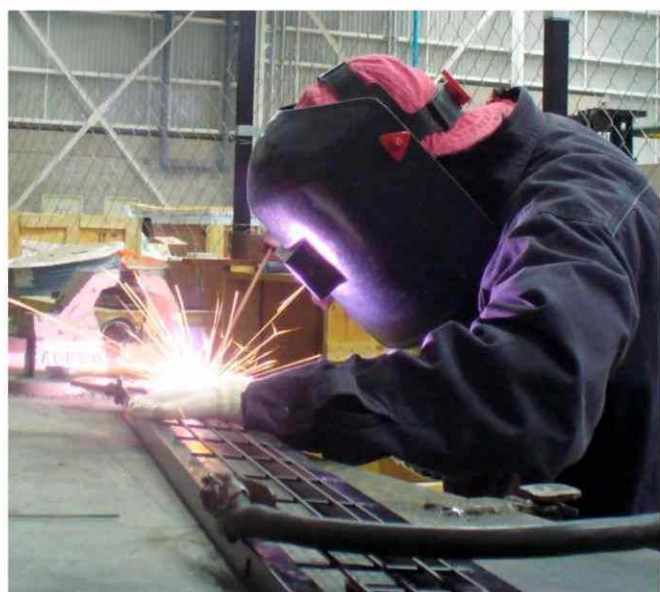
Elaboración de protecciones para islas de soldadura, Gestamp, Toluca, México
