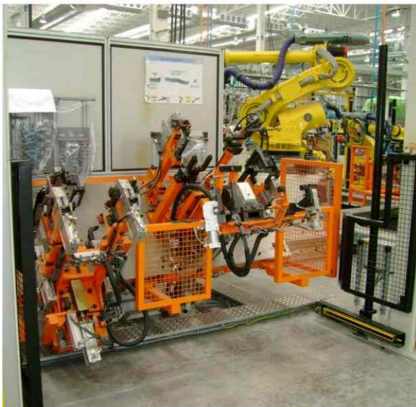
Montaje y elaboración de estación de trabajo, mesa giratoria, Gestamp, Toluca, México
